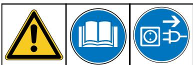
Vor Arbeiten an der Maschine muss die Bedienungsanleitung gelesen und verstanden sowie der Stromstecker abgezogen und der Druckkessel entleert werden.
