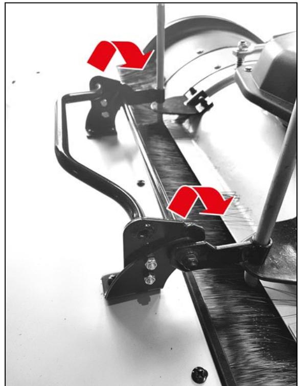
6. Abschließend die Zugstange (14) in die beiden Haltenasen einklipsen.
