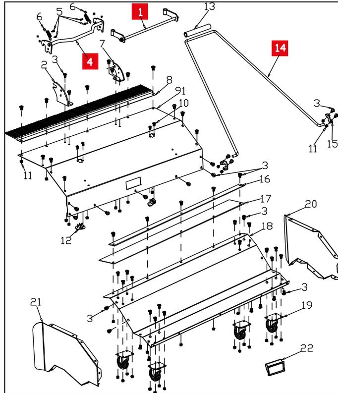
1. Vormontierte Halterung (4) links und rechts mit je zwei Schrauben M6x12 mit Stopmutter am Kehrgutsammelbehälter – oben – montieren.
