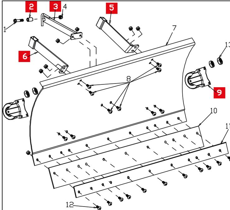
1. Beidseitig die Laufrollen (9) mit je vier Schrauben M8x30 mit Stopfmutter – an der Rückseite (nahe der Schürfleiste) am Schneeräumschild – montieren. **Achtung!** Jeweils beim oberen Schraubensatz eine zusätzliche Mutter M10 (13) als Abstandshalter einbauen, wie in der folgenden Abbildung gezeigt.
