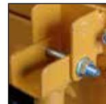
Den Griff (4) an der Halterung mit Hilfe von 1 Schraube (M8x60) und Mutter montieren.
